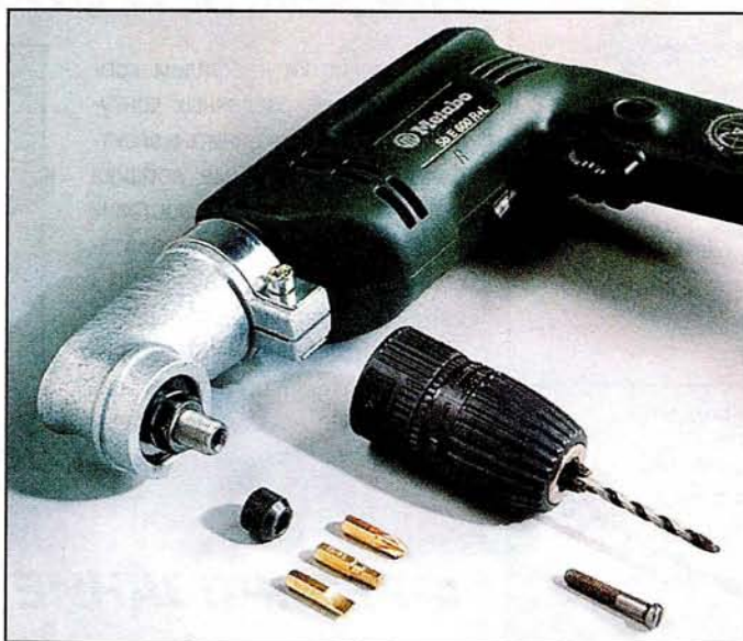
Угловая насадка на электродрель позволяет сверлить отверстия, ввинчивать болты и шурупы в труднодоступных местах. Зажим для сменных бит или сверлильный патрон навинчивается на шпиндель насадки.
