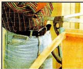
13 Установив наклонную «лестницу» под нужным углом, вертикальную «лестницу» соединяют шурупами с боковой стенкой тумбы и на крючке — с задней стенкой.
