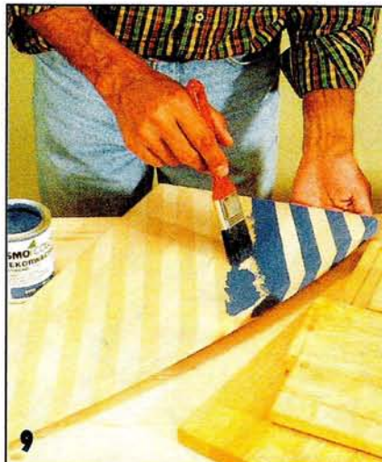
9 На одинаковом расстоянии друг от друга на дверку тумбы наклеивают отрезки малярной ленты. Затем дверку окрашивают в синий цвет. После удаления малярной ленты полосатую поверхность покрывают бесцветным лаком.
