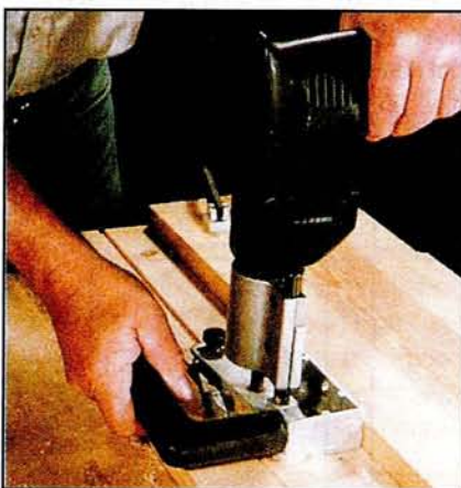
Оснащённую фрезой по дереву электродрель используют как фрезерную машинку и как настольное и ручное фрезерное устройство.
